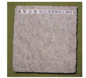
石綿飛散防止剤塗布 衝撃試験結果
